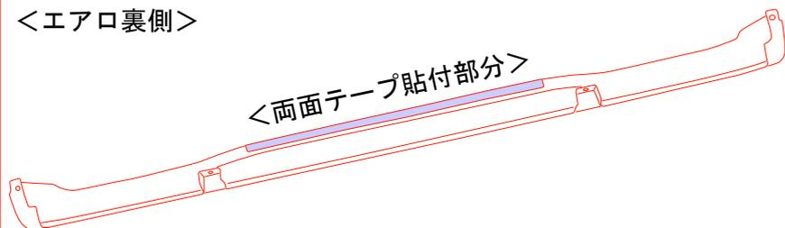
両面テープ貼付部分をパーツクリーナー等でパーツ側ボディ側を脱脂してエアロパーツ側に両面テープを貼り付けて下さい。
