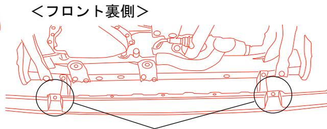
純正バンパーの穴を流用し付属のボルトナットにて取付をします。
